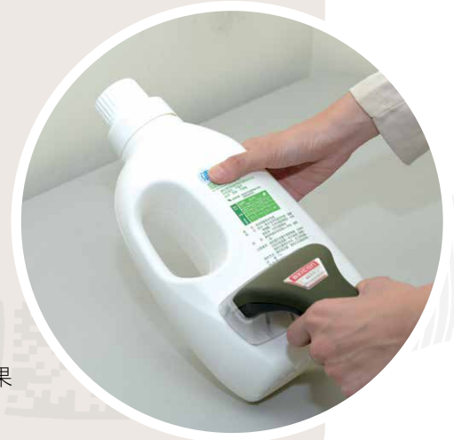
圖2、以一維條碼檢測器檢測條碼符號
