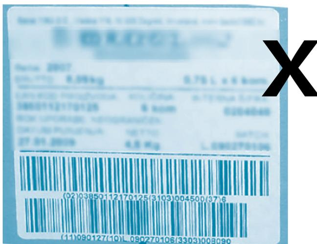
圖8-6 錯誤舉例：使用AI(02)和AI(37)卻沒使用SSCC，且該物流標籤上的條碼符號左側淨空區不足。
