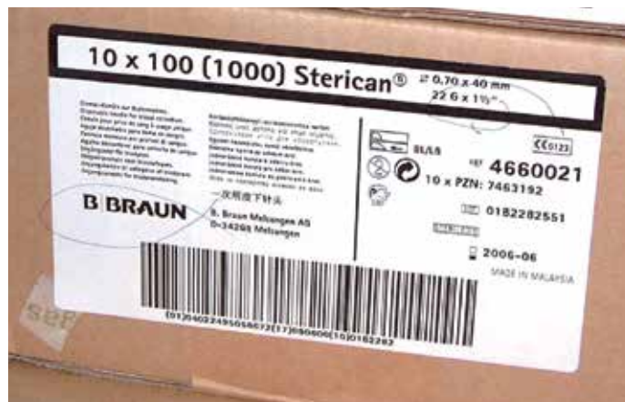
圖4、外包裝單位印製條碼符號GS1-128
